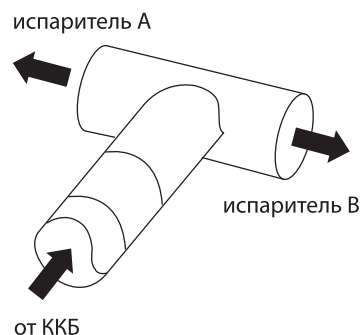
Рисунок 33. Подключение двух испарителей
