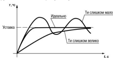
Рис.24. –Влияние T_i на выход на уставку.
