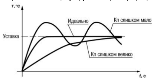
Рис.23. –Влияние K_p на выход на уставку.
