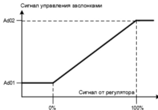
Рис.17.- Алгоритм работы смешивающими заслонками.
