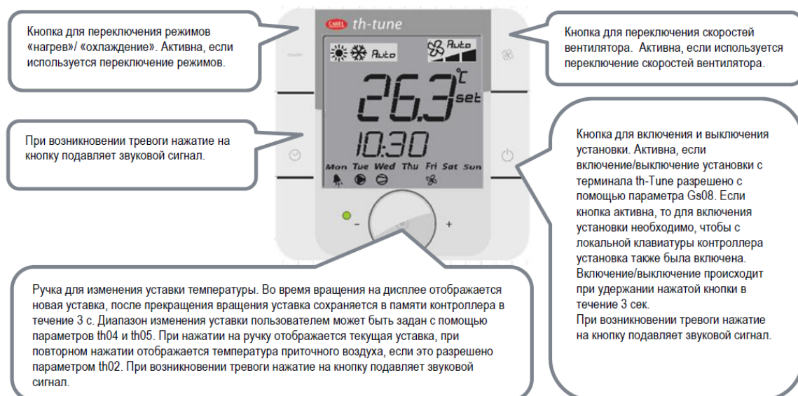
Рис.26. - Описание кнопок дисплея терминала th-Tune.
