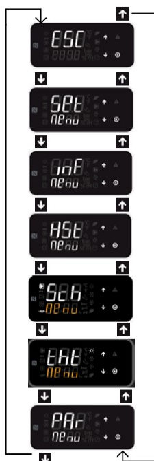
Рис 8. - Алгоритм выбора режима работы установки.
