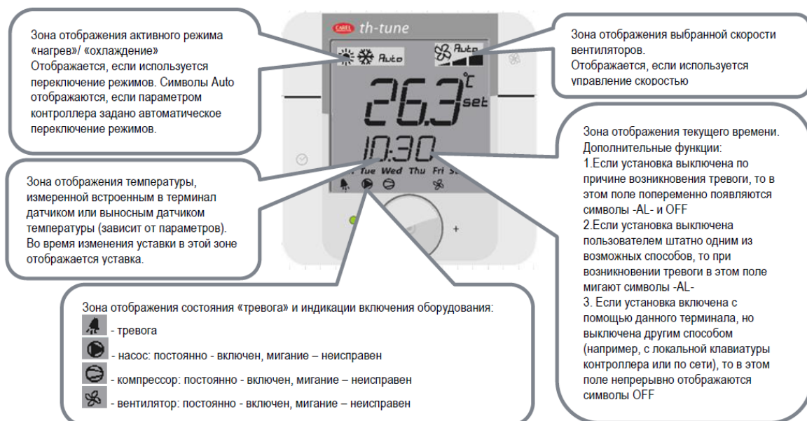
Рис.25. - Внешний вид и описание дисплея терминала th-Tune.
