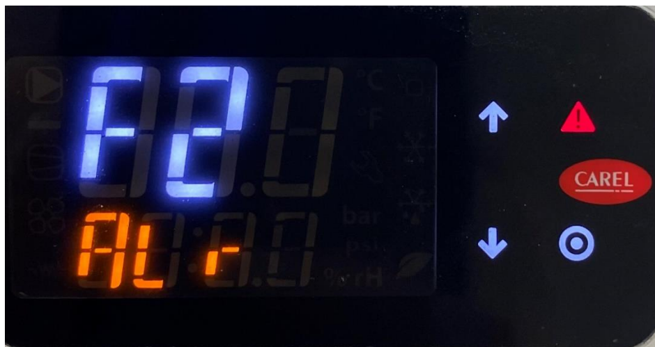
Рис.5.- Главное меню контроллера. (Вентилятор 2).
