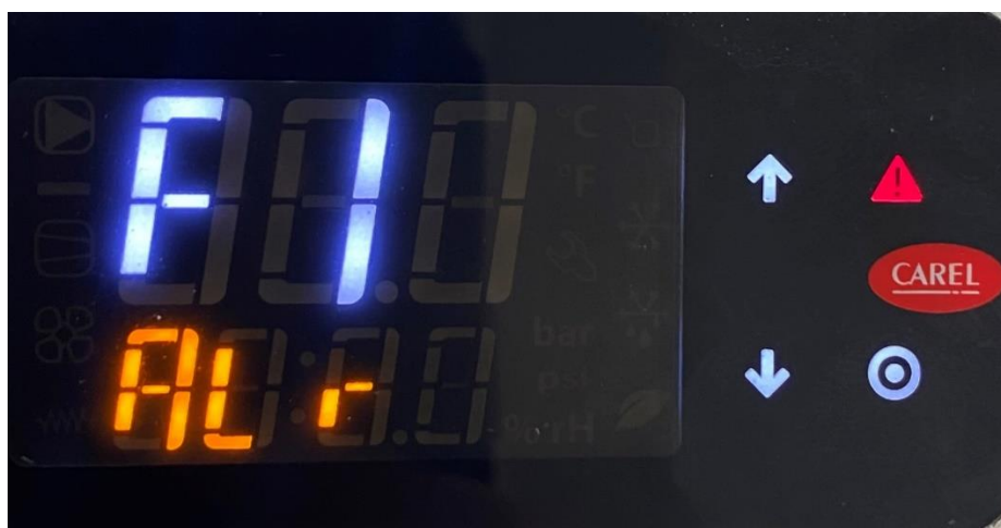
Рис.4.- Главное меню контроллера. (Вентилятор 1).
