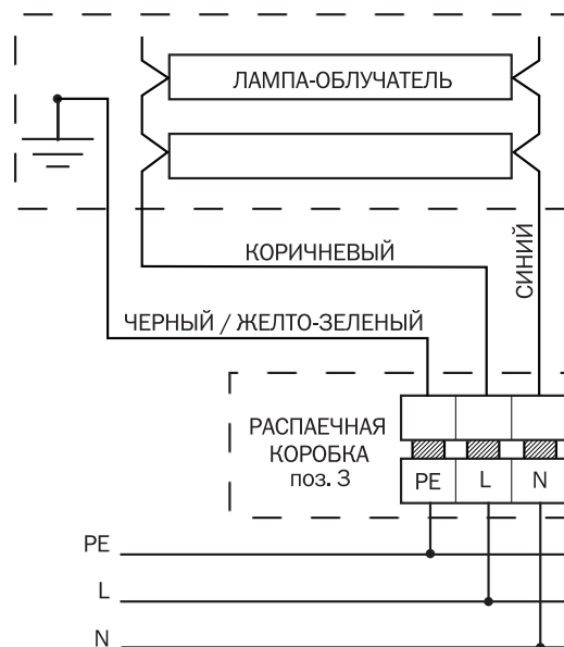
Рисунок 54. Схема электромонтажа секций
